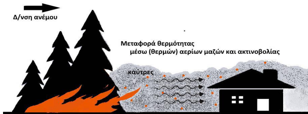
Σχέδιο 4: Τρόποι ροής της θερμότητας σε μια δασική πυρκαγιά, που εξελίσσεται πλησίον κτιρίου και απεικόνιση πιθανού τρόπου μετάδοσης δασικής πυρκαγιάς με μεταφερόμενες καύτρες σε κτίρια παρουσία ισχυρού ανέμου
